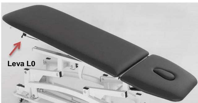
Il lettino ELIA può assumere la posizione Trendelenburg. Il piano è regolabile mediante molla a gas con sblocco controllato tramite apposito comando. Per regolare l'inclinazione del piano premere il comando (L0) e regolare nella posizione desiderata; rilasciare la leva L0 per mantenere la posizione raggiunta.
