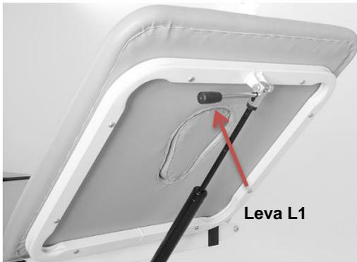
La testata è regolabile mediante molla a gas con sblocco controllato tramite apposito comando. Per regolare l'inclinazione della sezione premere il comando (L1) e regolare nella posizione desiderata; rilasciare la leva L1 per mantenere la posizione raggiunta.
